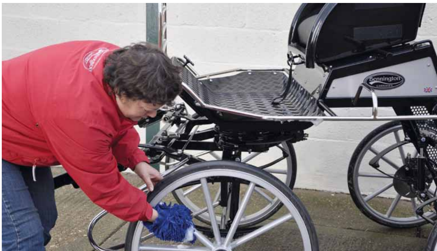
Wheel cleaning with a mit
